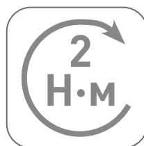
Увеличенный момент затяжки клемм – 2 Нм
