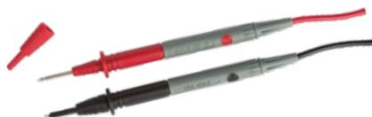
Щупы являются неотъемлемым аксессуаром любого прибора. Провода, из которых выполнены щупы для приборов EKF, обладают высокой гибкостью и надежной изоляцией. Поверхность возле основания держателя рефленая, чтобы щуп удобно и жестко удерживался в пальцах при проведении измерительных работ. Предусмотрен плотный выступ у места захвата пальцами для предотвращения соскальзывания и обеспечения упора. На всех измерительных щупах EKF указаны категория и рабочее напряжение.
