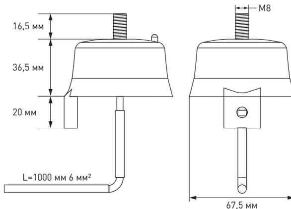
Рис. 1 – Габаритные и установочные размеры ограничителей перенапряжения LVA-280B-CL и LVA-440B-CL
