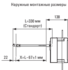
Рисунок 13в – Монтажные размеры при установке на дверцу шкафа для рубильников 250 А
