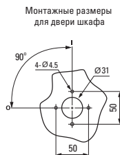
Рисунок 13в – Монтажные размеры при установке на дверцу шкафа для рубильников 250 А
