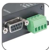
Стандартные интерфейсы RS485 и RS232
