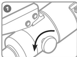
**Поверните винт сброса давления в положение «Открыть».**
