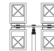
Выкрутите винт с пластиковым барабашком из штатива в верхней его части, вставьте винт в центральное отверстие консоли, закрутите винт. Пластиковые барабашки винтов консоли слева и справа должны смотреть вверх.
