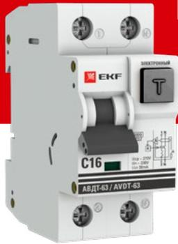
Автоматический выключатель дифференциального тока АВДТ-63 EKF PROxima – это аппарат, сочетающий функции автоматического выключателя с электромеханическим или электронным УЗО. При обнаружении автоматическим выключателем в защищаемом участке сети тока утечки (повреждения) на землю или сверхтока (тока перегрузки или короткого замыкания) происходит срабатывание устройства, приводящее к отключению защищаемой сети. Возможна коммутация алюминиевым и медным проводником.
