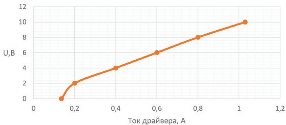
Рис. 5. Зависимость выходного тока драйвера от уровня напряжения на выводах управления
