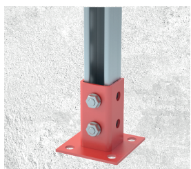
Основание потолочной стойки для страт-профиля 41x41 OUP41-41
