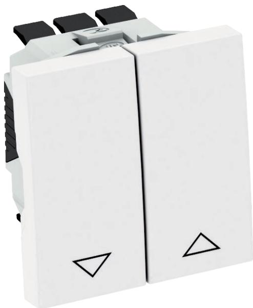
Переключатель жалюзи с электрической и механической блокировкой, 1-полюсный, 10 А, 250 V~, с клеммами.
