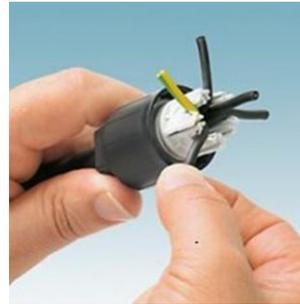
5. Обрезать провода заподлицо с кабельным соединителем кусачками (бокорежами);
