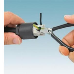
6. Установить кабельный соединитель в исходное положение (соединить разъемы) с усилием 3Нм.
