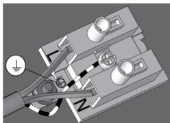
4. При использовании регулируемого ЭПРА, управляющие провода подключаются строго с соблюдением полярности, указанной в маркировке.
