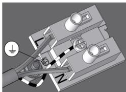
4. При використанні регульованого ЕПРА, керуючі проводи підключаються строго з дотриманням полярності, зазначеної у маркуванні.
