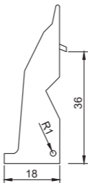
Рис. 9 - Габаритные размеры держателя PM-22-36 EKF AVERES
