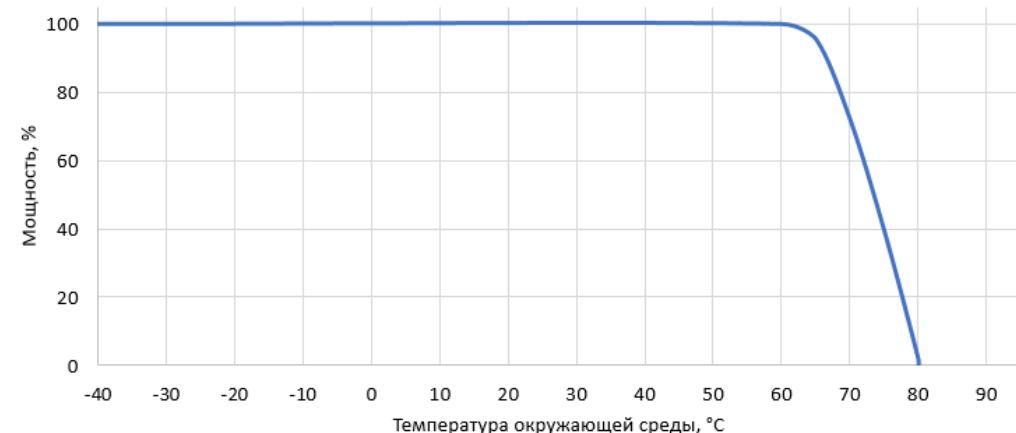
Зависимость мощности при максимальной нагрузке от температуры точки T<sub>c</sub>.
