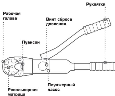
В процессе достижения максимального рабочего давления возникает встречная нагрузка и срабатывает клапан автоматического сброса давления (АСД) (в инструменте с АСД)
