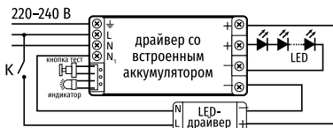
Схема подключения БАП в светильнике DSP-AC-40-LED-A
