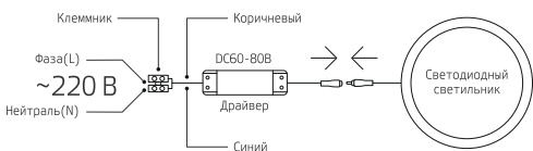
Рис. 2. Схема подключения светодиодного светильника к электросети 220 В
