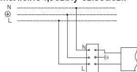
2. Резервтік қуаттандыру блогы бар қуаттандыру желісіне қосу сұлбасы : (сур. а - Резервтік қуаттандыру блогы).
