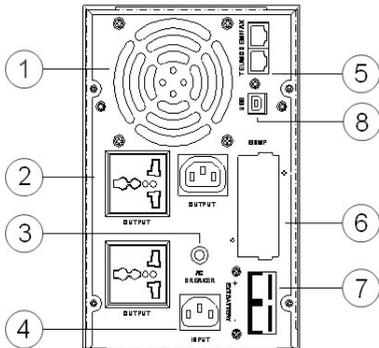
Корпус Tower. Задняя панель ИБП
