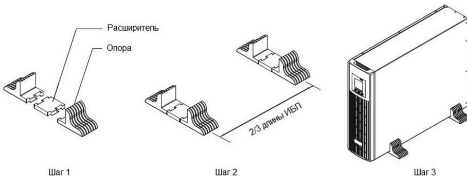
**Установка в стойку.** Для установки ИБП в стойку предварительно необходимо прикрепить к корпусу с помощью винтов боковые кронштейны (смотри рисунок ниже). В стойке для установки рекомендуется использовать полки или салазки. Будьте внимательны, не устанавливайте ИБП вверх ногами.
