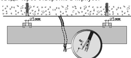
5. Установить корпус на поверхность потолка:
