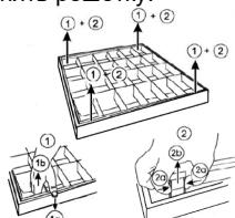
3. Вщелкнуть опору в корпус светильника:
