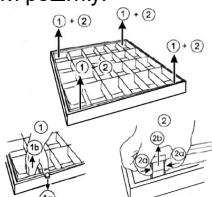
3. Вклацнути опору в корпус світильника.
