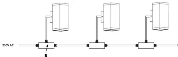
7. Подвести с помощью клеммников и герметичных распределительных коробок В (не входят в комплект поставки светильника) кабели питания/управления. Подключать провода необходимо в соответствии с полярностью «L» – фаза, «N» – ноль, заземление.
