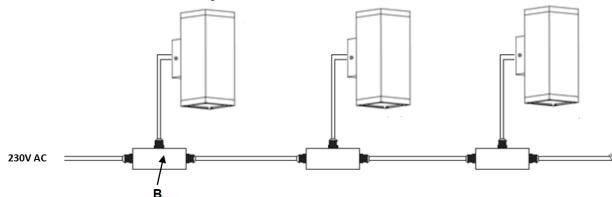
7. Підвести за допомогою клемників та герметичних розподільних коробок В (не входять до комплекту поставки світильника) кабелі живлення / управління. Підключати дроти необхідно відповідно до полярності «L» - фаза, «N» - нуль, заземлення.
