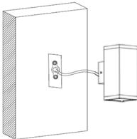
5. Установить светильник на монтажное основание, вкрутив винты.
