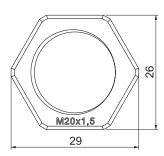
Размер Е 29,00 мм Размер L 6,00 мм Размер под ключ 26,00 мм Вид резьбы Метрический Резьба M20 x 1,5 Номинальный размер 20,00 метрической резьбы/PG Усилено стекловолокном  $\checkmark$ Без галогена  $\checkmark$ Удароустойчивый
