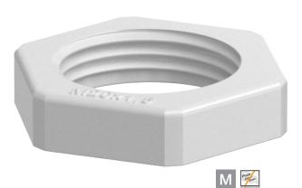
Контргайка согласно DIN 46319, с метрической резьбой согласно IEC 423. Указание: контргайки из полистирола необходимо затягивать умеренно, во избежание образования трещин вследствие перетяжки!
