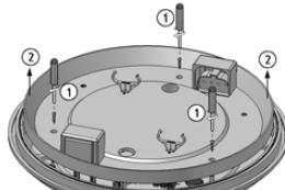
3. Провести сетевые провода через проходной изолятор в корпус светильника.
