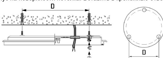
5. Подключить сетевой провод к клеммной колодке в соответствии с указанной полярностью.
