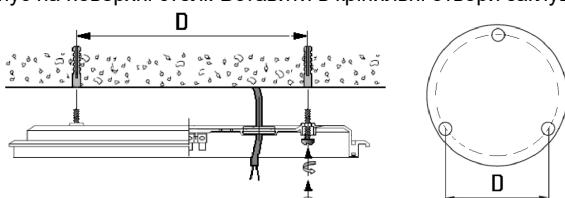
5. Підключити мережевий провід до клемної колодки відповідно до зазначеної полярності.
