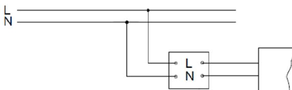
2. Схема підключення світильника до мережі живлення. CD 218.
