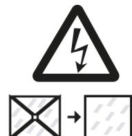
1. Распаковать светильник и снять с него рассеиватель.
