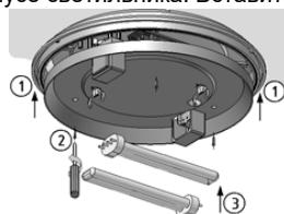
7. Установить рассеиватель и зафиксировать его винтами.
