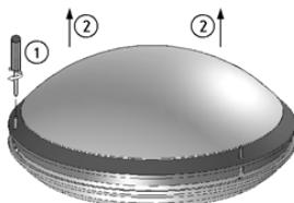
2. Снять отражатель.
