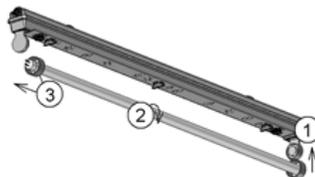
9. Светильник ВАТ укомплектованный электронным пускорегулирующим аппаратом и блоком резервного питания.
