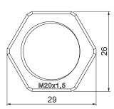
Размер Е 29,00 мм Размер L 6,00 мм Размер под ключ 26,00 мм Вид резьбы Метрический Резьба M20x1,5 Номинальный размер 20,00 метрической резьбы/PG Усилено стекловолокном  $\checkmark$ Без галогена Удароустойчивый
