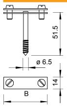
Размер В 62,00 мм проводники тах. FL40 мм Промежуточная пластина  $\Box$
