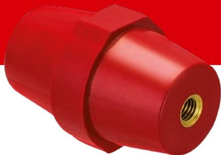
Шинные изоляторы серии SM «Бочонок» без болта EKF BASIC применяются для крепления токопроводящих шин внутри силовых шкафов или других устройств, для неподвижной фиксации и изоляции частей, находящихся под напряжением, от корпуса и панелей сборки с последующим подключением силовых проводников для распределения электроэнергии внутри щита. Крепление шинного изолятора осуществляется с помощью болта и шайбы к монтажной пластине или корпусу с одной стороны и к токоведущей шине – с другой.
