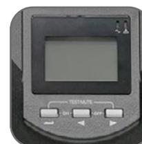
Большой LCD-дисплей, отображающий параметры входной и выходной сети, рабочую температуру, уровень нагрузки и заряда аккумуляторных батарей
